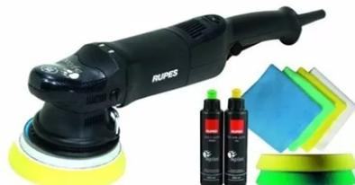
Электрическая эксцентриковая полировальная машинка с 15-мм ходом эксцентрика для обработки свежеокрашенных поверхностей, удаления частиц пыли и устранения голографического эффекта.
