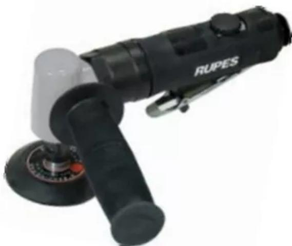
**Угловая полировальная пневматическая минимашинка LH76P** с регулятором оборотов и с рукояткой с правой стороны. Частота вращения: 5000 об/мин., диаметр диск-подошвы 75мм, рабочее давление: 6,2 бар., расход воздуха: 644 л/мин
